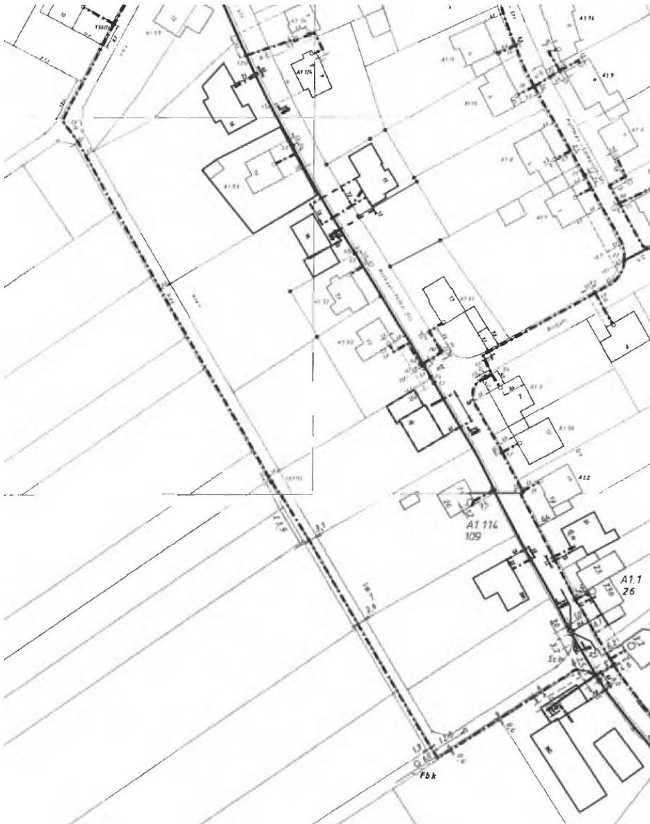
Abbildung 2: Bestandsleitungen der Deutschen Telekom im Planungsbereich „Auf Sand“
